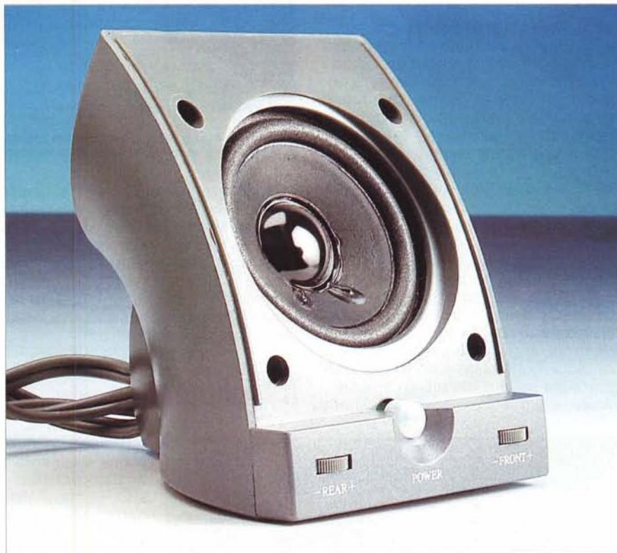
I satelliti sono ricavati da uno stampo in plastica e impiegano un singolo altoparlante larga banda da 6,25 cm di diametro. Sul satellite del canale anteriore destro sono posti il pulsante di accensione e il volume delle due sezioni, frontale e posteriore.
